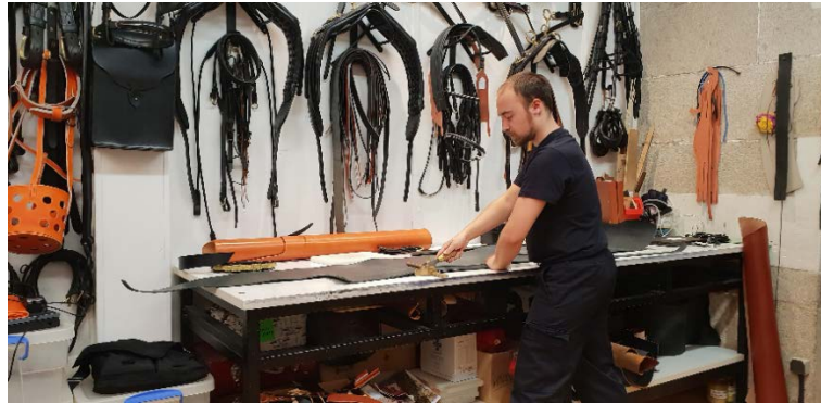
Cortando correas para tirantes guarnición inglesa
